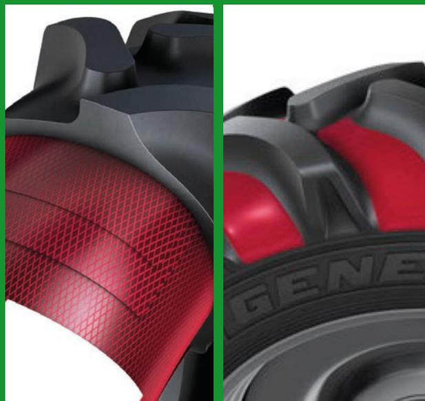
Los neumáticos General Tire V.Ply cuentan con hasta 20 capas de fibra de polímero de alta resistencia
