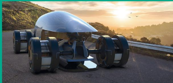
"Aeroflow" es un neumático concebido para su empleo en el automovilismo para lograr una carga máxima aerodinámica. Para ello, la rueda se ensanchó con una banda de rodadura separable, optimizando así el agarre del neumático. Las ruedas se equiparon con álabes de turbinas para absorber el aire durante la marcha y generar a partir de ahí una carga aerodinámica adicional si fuera necesario.
